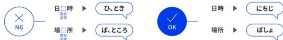
図3.9 文字間隔の調整に空白文字（スペース）を使うと、スクリーンリーダーで正しく読み上げられないことがある
